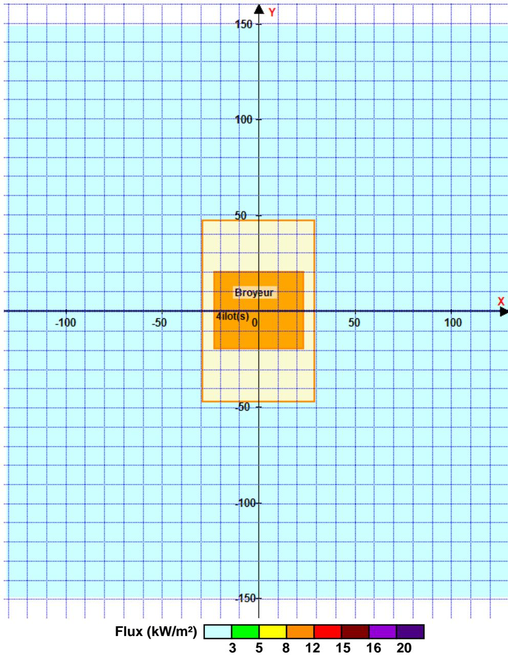
Pour information : Dans l'environnement proche de la flamme, le transfert convectif de chaleur ne peut être négligé. Il est donc préconisé pour de faibles distances d'effets comprises entre 1 et 5 m de retenir une distance d'effets de 5 m et pour celles comprises entre 6 m et 10 m de retenir 10 m.
